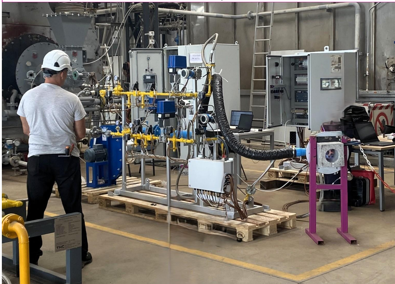
©Fives : brûleur hydrogène/gaz naturel de Fives testé et validé par Toyota
