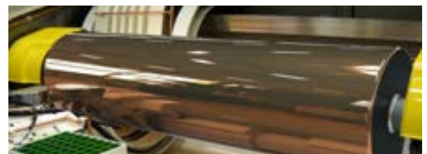
EcoR utilizado para moldear el rodillo para el proceso de curado UV
