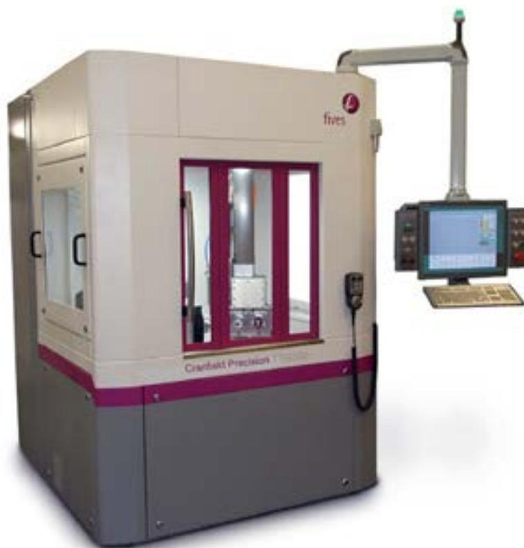
Plataforma de mecanizado de forma libre de ultraprecisión para componentes de hasta 350 mm de diámetro
