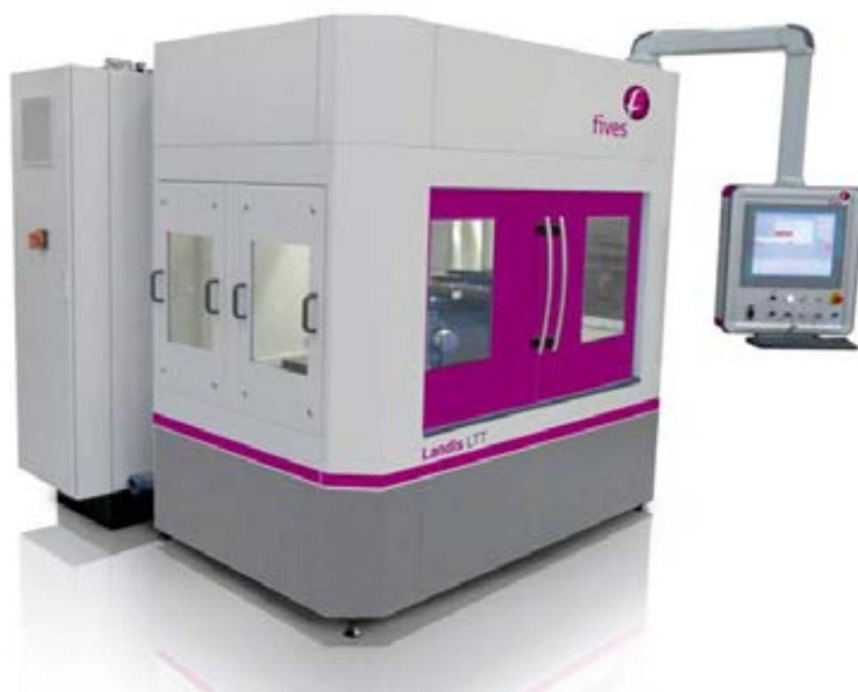
Solución de múltiples husillos y torreta doble para rectificar diámetros exteriores, interiores, caras, conos, diámetros concéntricos y excéntricos a tolerancias submicrónicas en una sola sujeción
