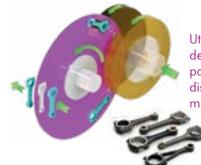
Utilizado para el rectificado de superficies planas y paralelas de bielas, diseñado para producción media
