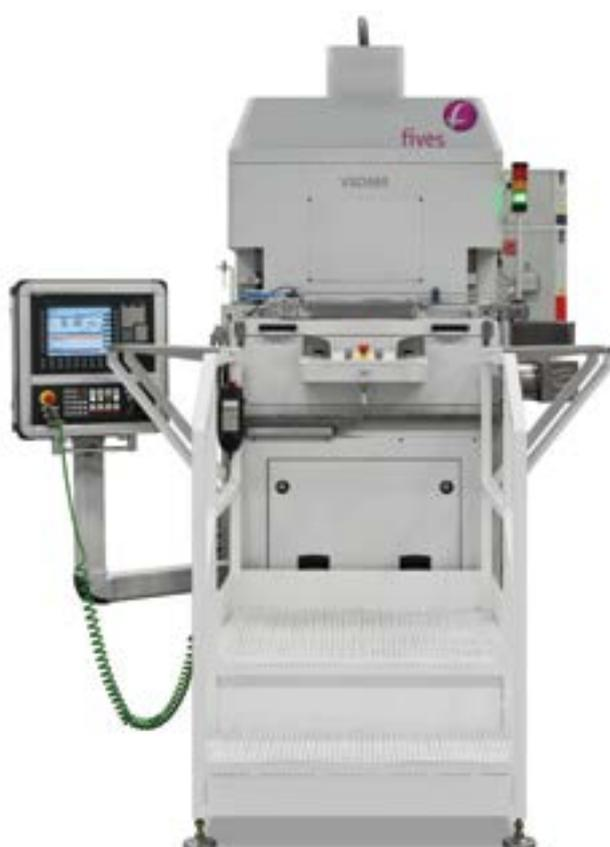
Rectificadora vertical de un solo disco con sistema de sujeción combinado, desarrollada para el procesamiento de engranajes solares
