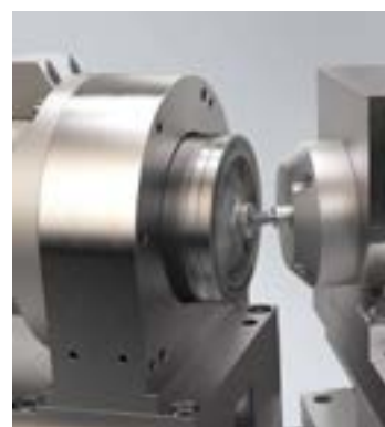
Cabezal de trabajo en ángulo de 30°, configuración de rectificado interno
