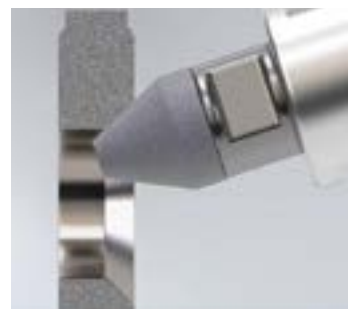
Cabezal de trabajo en ángulo de 30°, configuración de rectificado interno
