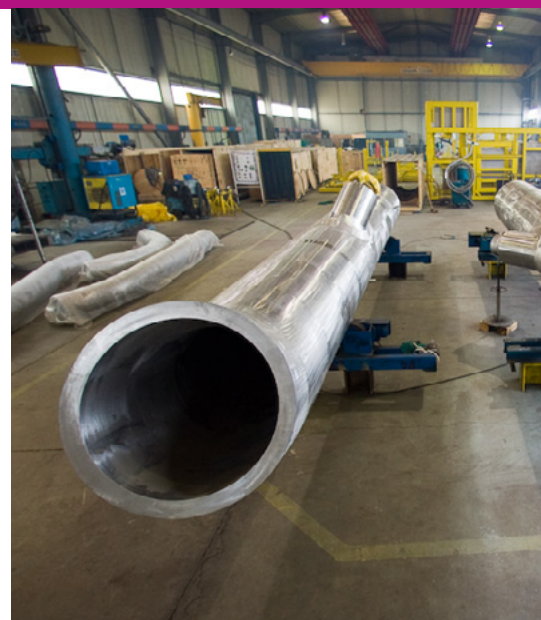
Tronçons du circuit primaire de centrale nucléaire
