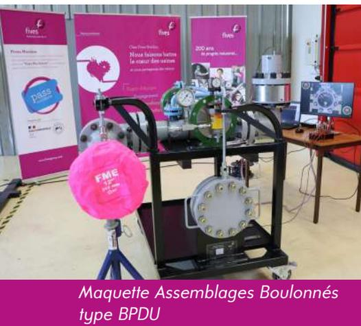
Maquette Assemblages Boulonnés type BPDU
