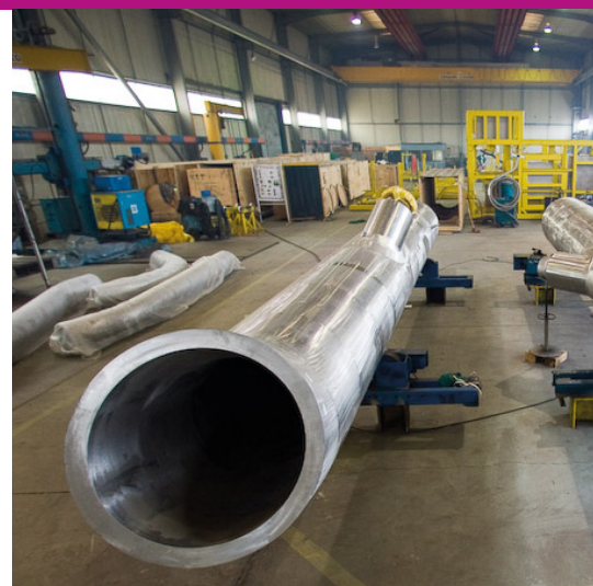
Tronçons du circuit primaire de centrale nucléaire
