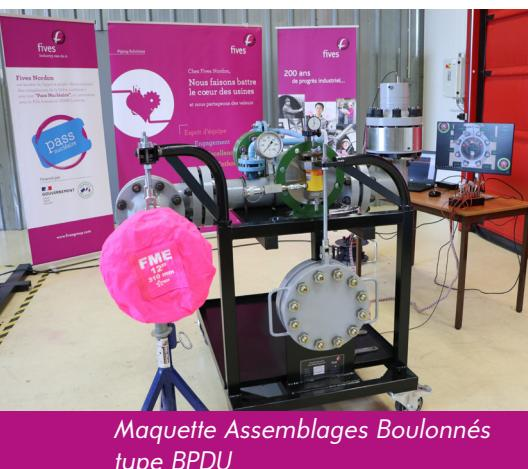
Maquette Assemblages Boulonnés type BPDU
