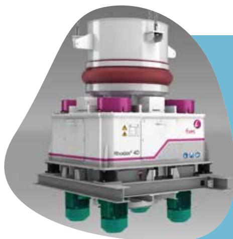
Le broyage sélectif du FCB Rhodax®, lié à la compression en lit de matière, libère de façon optimale les trois matériaux constituant le béton, les granulats, le sable (0,125-2 mm) et la pâte de ciment (0-0,125 mm), qui seront ensuite séparés et récupérés.
